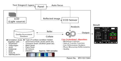
Figure 2 - TAMS<sup>™</sup> System Diagram
